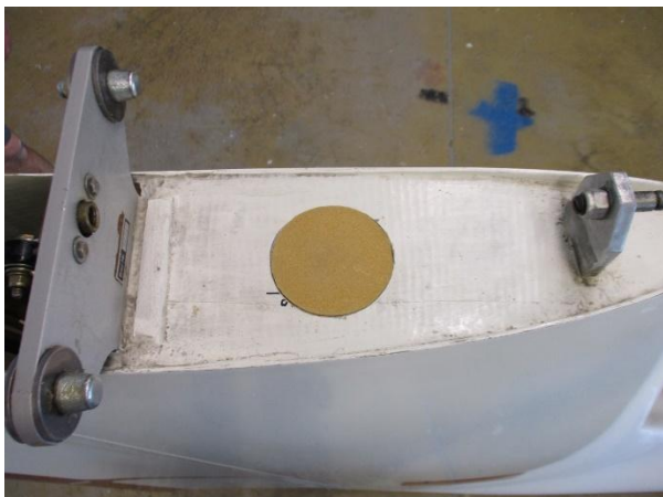
Ausschwenken mit Korrosionsschutz und Einsetzen neuer Rohrriev Rinsing with corrosion preventive and insert new tubular rivet
