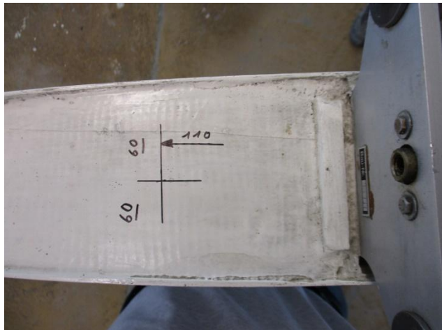
Anzeichnen Position der Bohrung (110 mm vor Vorderseite Höhenflossenbeschlag in der Mitte der Rippe) Marking of the hole position (110 mm in front of elevator fitting in the middle of the rib)
