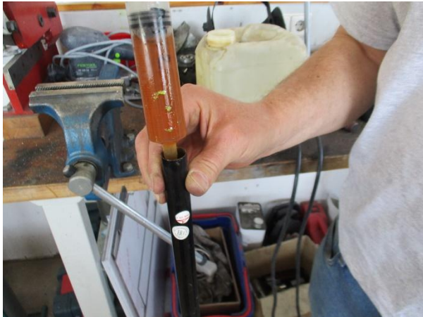
Ausschwenken mit Korrosionsschutz und Einsetzen neuer Rohrriev Rinsing with corrosion preventive and insert new tubular rivet
